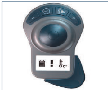
Figure 9 : affichage de la mise en garde température batteries sur le boîtier de commande
