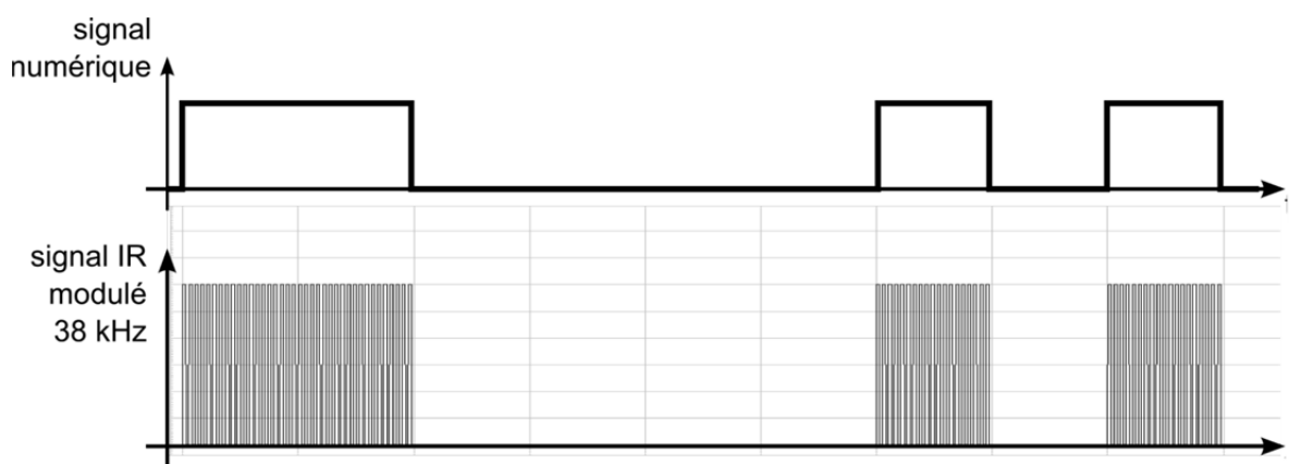
Figure 14 : modulation du signal infrarouge
